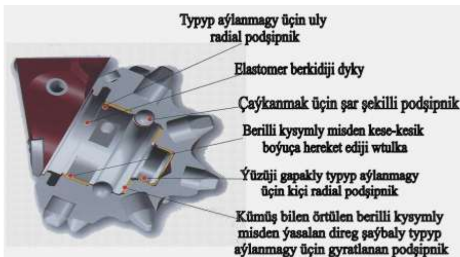
2.3-nji surat. AUM ugurda önderilýän dolotanyň şaroşkasynyň gurluş şekili
