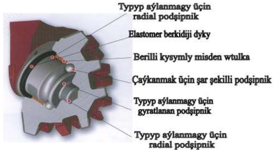
2.10-njy surat. AU ugurda önderilýän dolotanyň şaroşkasynyň gurluş şekili
